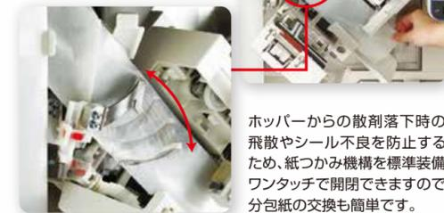
ホッパーからの散剤落下時の飛散やシール不良を防止するため、紙つかみ機構を標準装備。ワンタッチで開閉できますので、分包紙の交換も簡単です。
