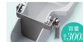
搭載散剤の秤量・分包に使用。散剤がこぼれないようゲートが設置されています。
