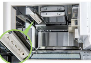
散剤は、摩擦などによる静電気が原因とされる帯電により、散剤経路に付着します。本製品では除電装置を電子天秤秤量部に装備し、イオンを発生させて帯電を中和することで、フィーダーシュートやホッパーへの散剤付着を軽減させます。
