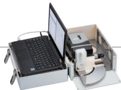
アジャスタブルカセット内のRFIDデータを書き換える専用キットです。専用のPCで変更する薬剤データの書き換えを実行し、接続するプリンターにてカセット正面の薬剤ラベルを発行します。
