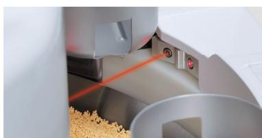
フィーダーから落ちる薬剤の「あり・なし」や、分割時の散剤堆積量などを各検知センサーが監視し、分包数によって自動補正します。分包が難しい顆粒の薬剤も、専用の「顆粒モード」で精度の高い分包ができます。
