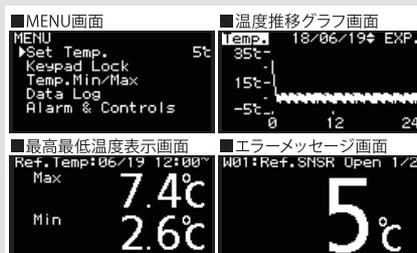
有機ELのコントロールパネルは、温度推移の表示や、制御温度の最高点と最低点表示、エラーのメッセージなど、様々なオペレーションが実行可能です
