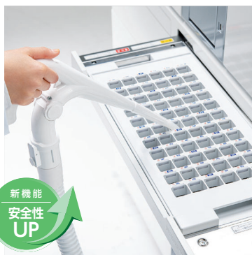
MTU部に入り込んだ錠剤の欠片や粉を手撒き作業前に清掃することで、コンタミ発生のリスクを抑制できます。
