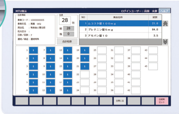
▲MTUを使用した際の指示画面。マス目の何番に何錠撒けばいいのかが配置図とともに表示されます。
