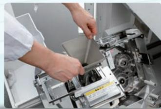
散剤を分包紙に投入するSHホッパーも設計を一新。薬剤が付着しにくい、つぎ目のない構造としました。簡単な操作で取り外しができるため、クリーナーによる清掃はもちろん、布を使った乾拭き・水拭きも可能です。
