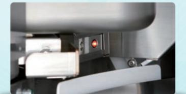
\*写真は散剤検知センサー。
