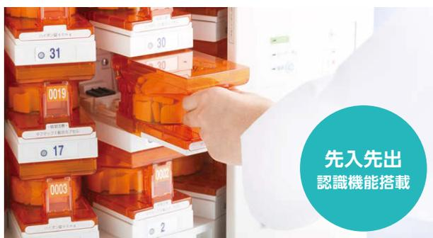
カセッターに内蔵した『RFID チップ』で、カセッターをどの位置に装着しても薬剤名を認識。薬剤の充填作業を効率化します。同一薬剤複数カセッターは充填日の古い薬剤から払い出す「先入先出」認識機能も搭載しています。
