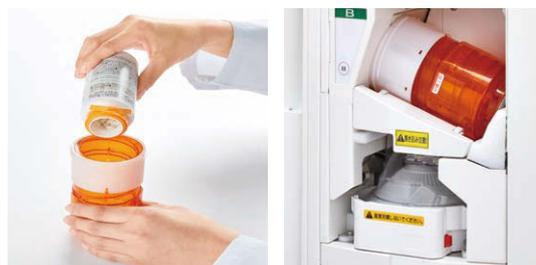
充填した薬剤を回転しながら整列させるマルチストッカー部と、それを1錠ずつ振り分けるマルチローター部で構成されたマルチカセッターで、確実な払い出しを実現しました。
