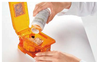
薬剤をカセッター内に充填しておけば、使いたい場合にカセッターを入れ替えるだけですぐに分包作業に入れます。
