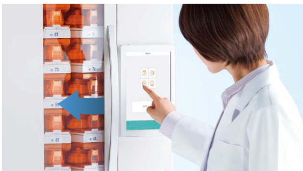
ボタンをタップするだけでドラムが回転し、パネル上で4分割されたドラムから清掃したいブロックを呼び出します。
