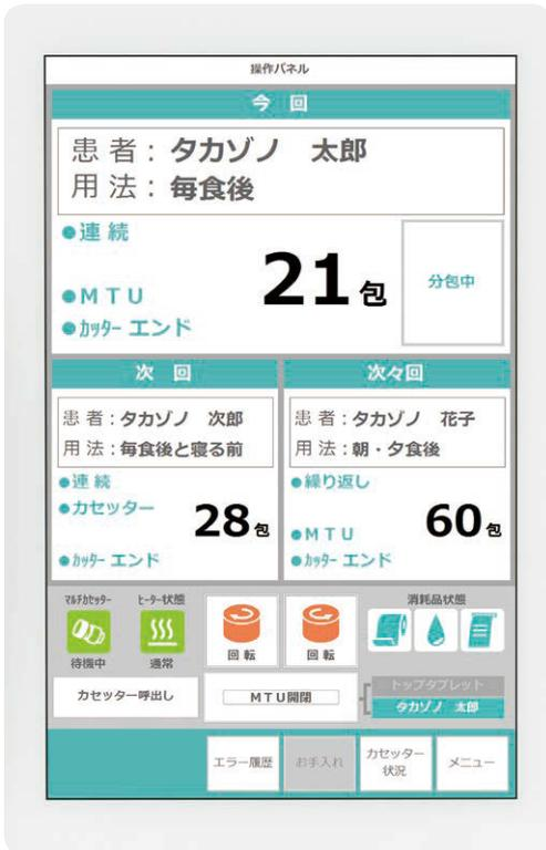
タッチパネル式なので状況確認や操作などを直感的に行えます。分包中のデータも3件分を表示。消耗品の状態もパネル上で確認できます。
