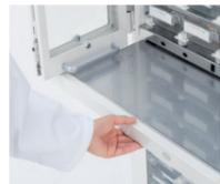
機械を止めて手でピッキングする場合、スライド式のテーブルを引き出せばその場でピッキングや充填作業ができます。
