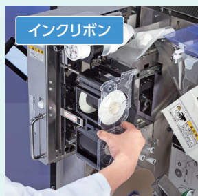
ワンタッチで着脱できるインクリボン
