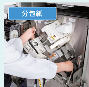
分包紙の交換も手で作業しやすい設計に
