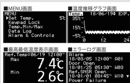
有機ELのコントロールパネルは、温度推移の表示や、制御温度の最高点と最低点表示、エラーのメッセージなど、様々なオペレーションが実行可能です。
